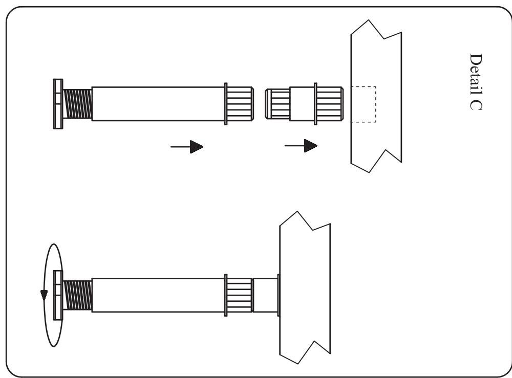
Falls sich im Beutel mit den Beschlägen (Beschläge im Päckchen des Doppelbett-Kopfteils) ein Stützfuss für den Mittelsteg gemeinsam mit einem "Adapter" befindet, ist wie folgt vorzugehen:
